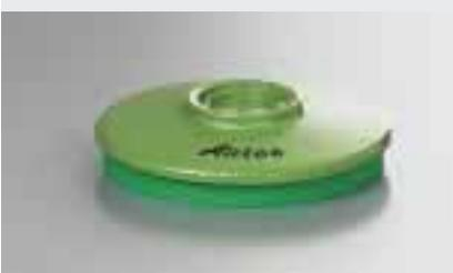
AirLoc è il fornitore con la scelta maggiore di zoccoli livellanti al mondo. La superficie di appoggio grande e piana offre un supporto ottimale per il banco macchina. Carichi elevati fino a 100 t per zoccolo livellante possono essere allineati rapidamente e con pochi sforzi con una precisione di  $\frac{1}{100}$  mm. Ciò comporta una riduzione dei tempi complessivi di installazione di una macchina.
