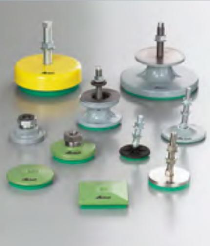
**Éléments PRG:** conçus pour une installation simple, économique et sécurisée de votre machine ou équipement. La liaison brevetée entre l'élément et la vis de nivellement est indissociable, supporte des charges élevées et peut tout de même compenser automatiquement des irrégularités du sol jusqu'à 4°. La pose sans ancrage et la mise à niveau aisée à course élevée garantissent une souplesse maximale de votre parc de machines.
